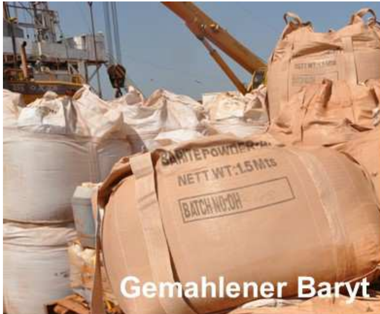
Abb. 6. Baryt auf einer Bohrstelle im Süd Sudan. Das Mineral Baryt (Schwerspat) wird wegen seines hohen spezifischen Gewichts in großen Mengen (15-35%) als Beschwerungsmittel dem Bohrschlamm zugesetzt. Mineralischer Baryt enthält häufig erhebliche Mengen an Blei. Foto: K. Stieglitz.
